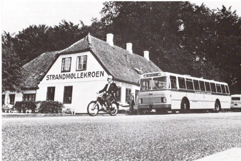
I 1973 leveredes den sidste bus til Holger Salomon. Det var en Volvo med norsk VBK-karosseri. Foto: O. Sommer A/S.
