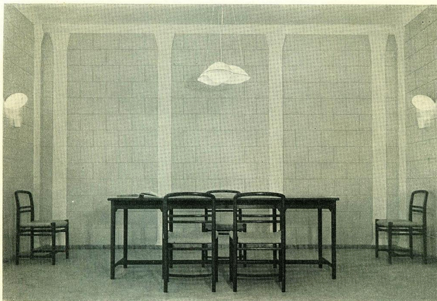
Bryllupsværelset. Pillastre og Kvaderfelter; Oliemalet Stuk. Gulv: Gjellebak Marmor. Møbler: Palisander. Over Bord Loftsbelysning tegnet af Gunnar Asplund
